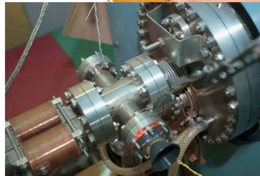
Узел конверсионной системы — источника позитронов
