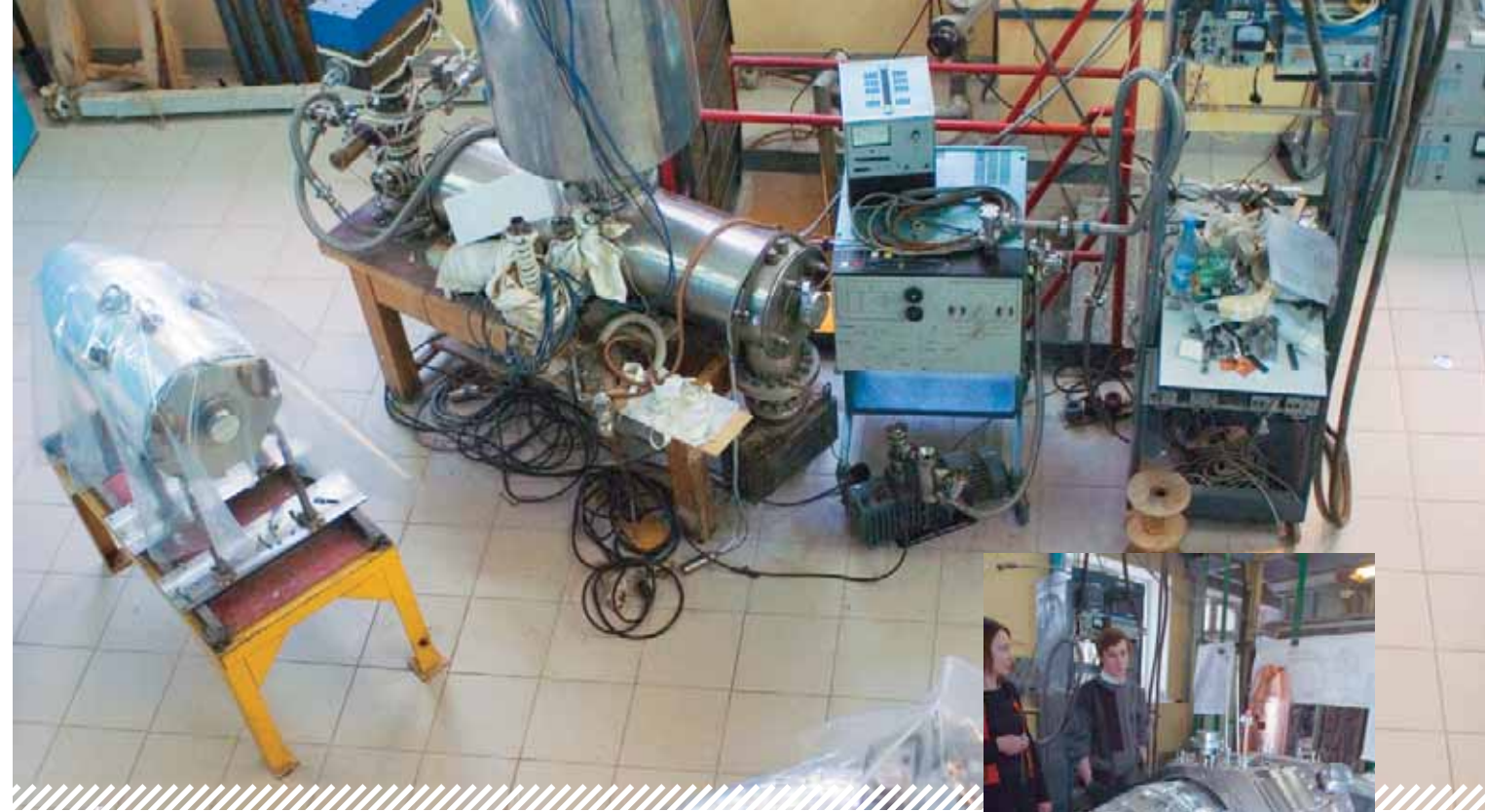
Сверхпроводящие соленоиды работают при очень низкой температуре, поэтому у каждого их блока есть буферный объем емкостью 200 л для хранения жидкого гелия (его температура — 4 °K или — 269 °C)
