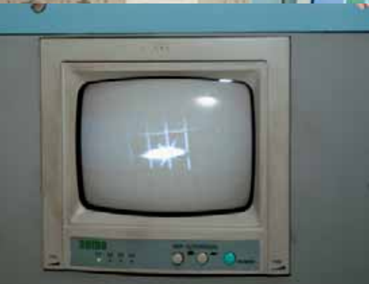
На экране монитора — фотонный «след» движущегося в ускорителе пучка частиц
