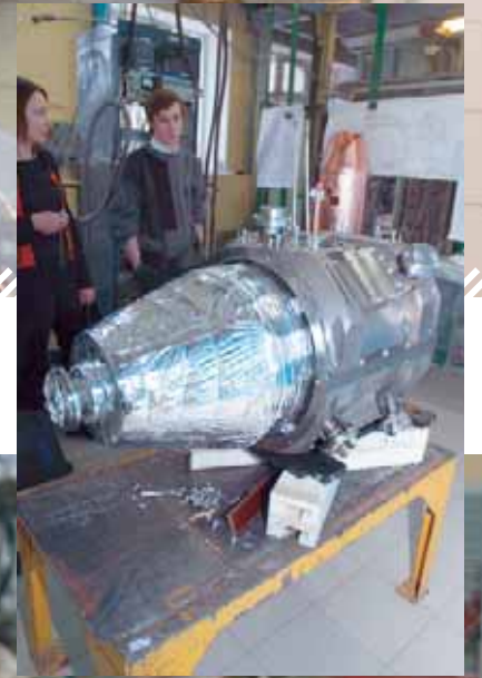
Сверхпроводящие соленоиды работают при очень низкой температуре, поэтому у каждого их блока есть буферный объем емкостью 200 л для хранения жидкого гелия (его температура — 4 °K или — 269 °C)
