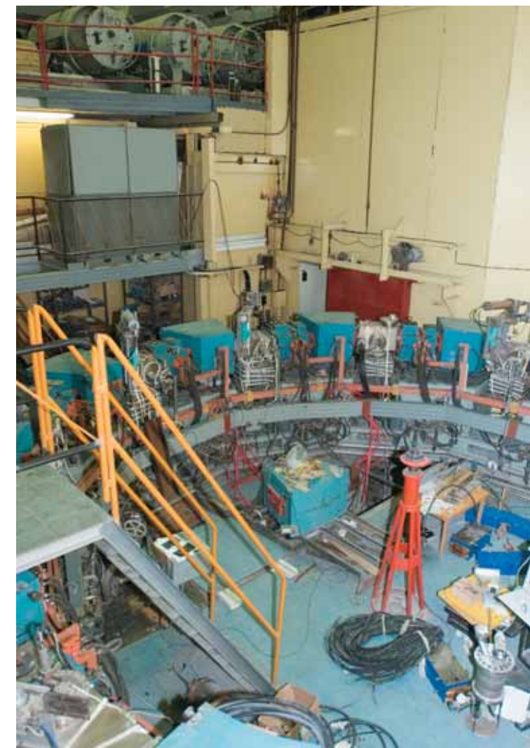
Комплекс ВЭПП-2М. Работал в диапазоне энергий 0,4 — 1,4 ГэВ. Максимальная достигнутая светимость — 5 \times 10^{30} см -2 × сек -1 на энергии 510 МэВ
