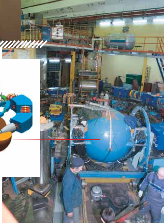
Детектор элементарных частиц СНД в экспериментальной промежулке вновь создаваемого ускорительного кольца ВЭПП-2000
